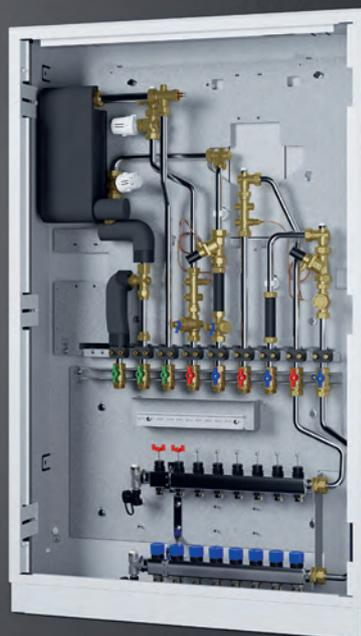
Als Multitasking-fähig können Sie diese Wohnungsstation bezeichnen. Sie verwenden sie speziell für den Einbau in 4-Leiter-Systeme. Zu diesem Zweck ist ein ungemischter Niedertemperatur-Heizkreis integriert. Das Gerät arbeitet mit einem Zwei-Speicher-System: Für die Trinkwarmwasserbereitung wird ein hohes, für die Versorgung der Fußbodenheizung ein niedriges Temperaturniveau angewendet.
