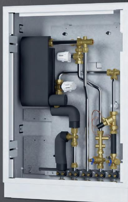
Wenn Sie Ihren Kunden eine verlässliche Lösung zur Trinkwarmwasserbereitung bieten möchten, ist diese Wohnungsstation ideal. Sie arbeitet mittels Platten-Wärmeüberträger aus Edelstahl im hygienischen Durchflussprinzip. Nutzen Sie die im Lieferumfang enthaltenen Mengenbegrenzer, die die Trinkwarmwassermenge bei Bedarf einfach und sicher auf den gewünschten Trinkwarmwasserbedarf anpassen.
