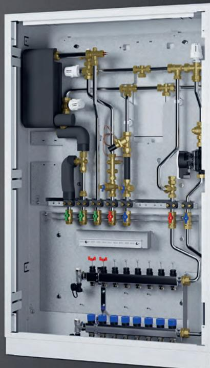
Vielseitig in ihrer Arbeitsweise zeigt sich diese Wohnungsstation. Sie setzen das Gerät nicht nur für die Versorgung mit Trinkwarmwasser, sondern auch für die Heizung ein. Letzteres ermöglicht ein thermostatisch geregelter gemischter Heizkreis.
