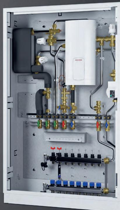
Trinkwarmwasser mit allen Komfortmerkmalen stellen Sie für Ihre Kunden mit dieser Wohnungsstation sicher. Das Gerät verfügt nämlich zusätzlich über eine elektrische Nacherwärmung durch den Einsatz eines Durchlauferhitzers. In dem ist ein spezielles Bypassventil verbaut, das Druckverluste drastisch reduziert.
